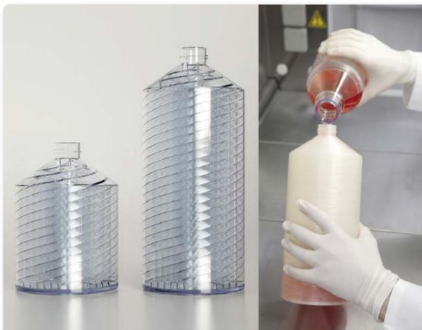
Die CellScrew gibt es in zwei Größen mit verschiedenen Wachstumsoberflächen (6K: 6.000 cm<sup>2</sup> und 10K: 10.000 cm<sup>2</sup>). Medium wird von oben durch einen zylindrischen Kanal eingefüllt und durch Rotation der archimedischen Schrauben wieder nach oben transportiert.
