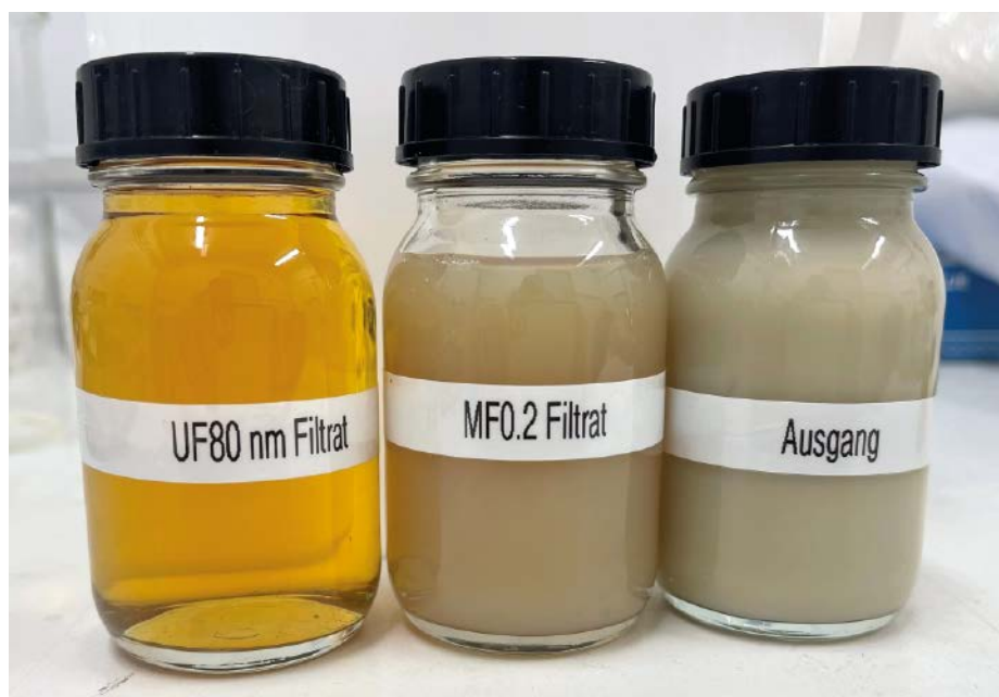
Abb. 1: Ergebnis der Filtration eines wasseremulgierbaren Kühlschmierstoffes
