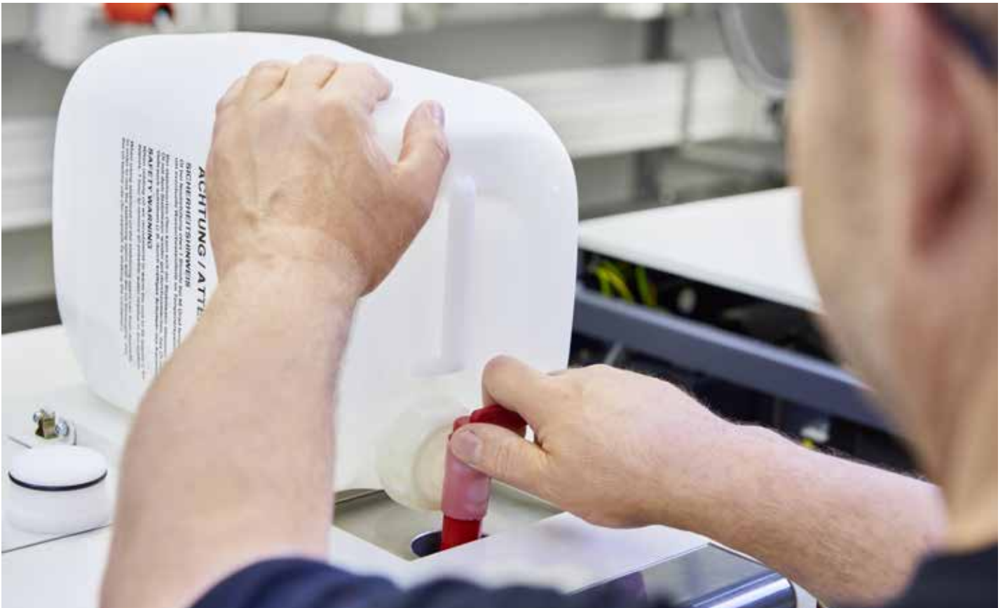
Die Befüllöffnung sollte so positioniert sein, dass das Befüllen so einfach und sauber wie möglich ist und keine verschüttete Flüssigkeit ins Gerät eindringt.
