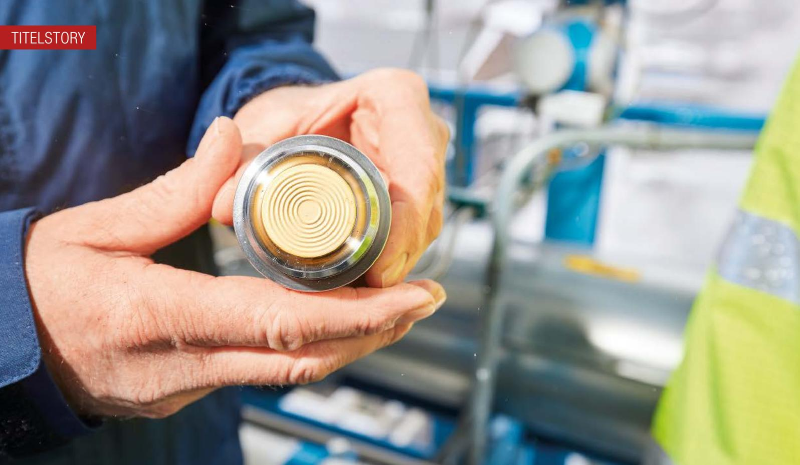
**Nahaufnahme der goldbeschichteten Metallmembran, die eine sichere Barriere für Wasserstoff darstellt und damit die Messungen stabil hält.**
