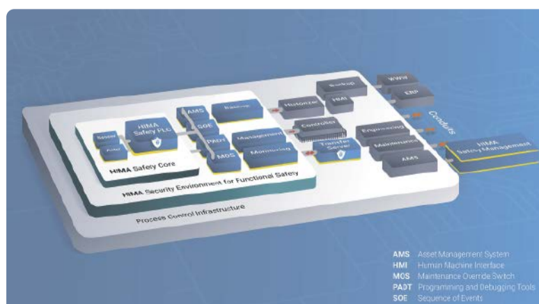
Das HIMA „Security Environment for Functional Safety“ trennt Safety and Security und ermöglicht es, die Sicherheit über den gesamten Lebenszyklus der Sicherheitslösungen aufrecht zu erhalten und gleichzeitig den damit verbundenen Aufwand zu minimieren.
