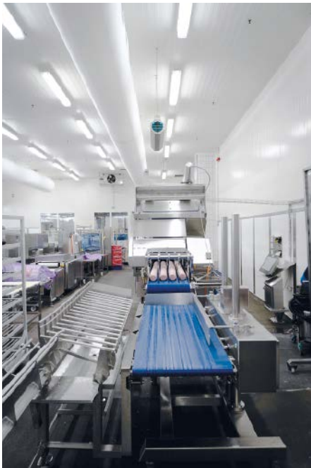
▼ Abb. 1: Die Sterilsystems-Durchlaufdesinfektionsanlage im Heilsbronner Werk der Fa. Kupfer dekontaminiert besonders empfindliche Slicerprodukte vor dem Entfernen des Kunststoffdarms von außen. © Hans Kupfer
