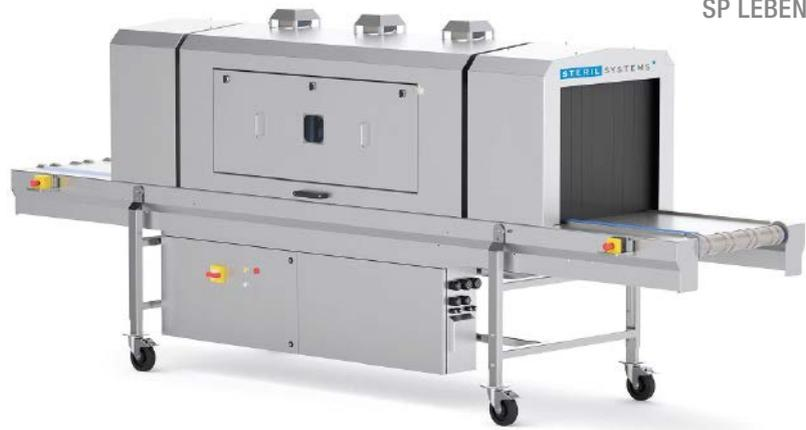
▲ **Abb. 2:** Das von den Sterilsystems-Anlagen abgegebene UV-C-Spektrum von 253,7 nm Wellenlänge führt zu einer zuverlässigen Reduktion der Mikroorganismen um bis zu 99,9 %. Die UV-C-Entkeimungstechnik funktioniert berührungslos und trocken, sodass es weder zu Feuchtigkeits- noch zu Resistenzbildung kommen kann. © Sterilsystems
