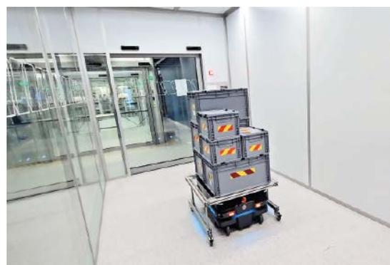
Abb. 4: Autonome mobile Roboter, die per Funk die Schiebetüren öffnen, fahren automatisch in die Materialschleuse ein
