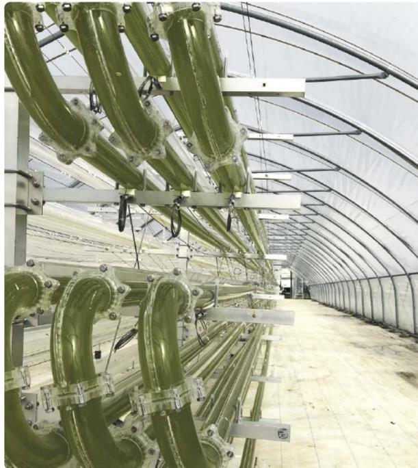
Pflanzen schwimmen in der Kultivierflüssigkeit und werden mit dieser fortlaufend durch das Röhrensystem gepumpt. Hierbei bewirkt Licht, dass sie sich durch Fotosynthese vermehren. Das hierfür notwendige CO<sub>2</sub> entnehmen die Mikroalgen der Flüssigkeit, in der sie sich befinden, und geben dabei den entstehenden Sauerstoff an diese ab. Nach einer gewissen Verweildauer entweicht
