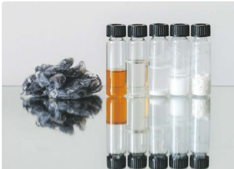
Der Re.resolution-Prozess (v.l.n.r.): Vom geschredderten Textil zum Hydrolysat und nach anschließender Entfärbung und Aufarbeitung zu kristallisierter Terephthalsäure.
