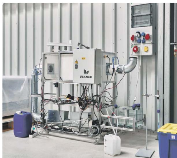
Ucano kombiniert in seiner Direct-Air-Capture (DAC)-Technologie einen Luft-Flüssigkeits-Kontaktor mit Elektrodialyse und biomimetischen katalytischen Additiven, um CO<sub>2</sub> effizient aus der Atmosphäre zu entnehmen.
